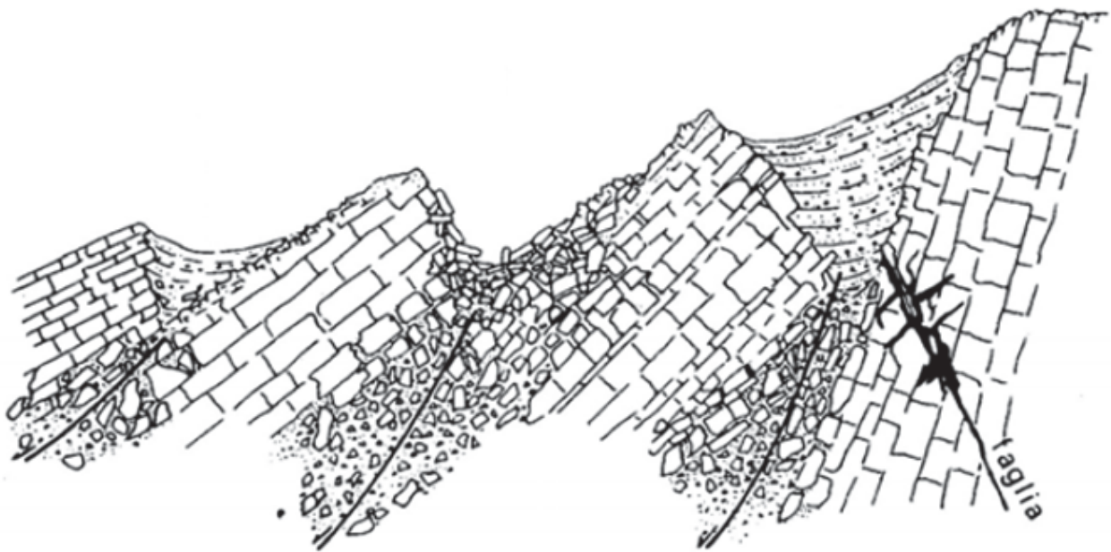
Figura 4.33 depressioni per scivolamenti e DGPV con fenomeni di piping in calcari. Immagine tratta dalle dispense del corso di Geomorfologia di A. Bini.
